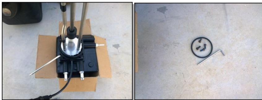
图 32 密封圈及螺栓拆卸
