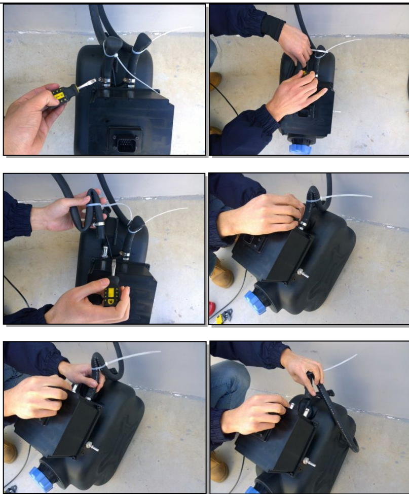
图 28 加热水路拆卸
